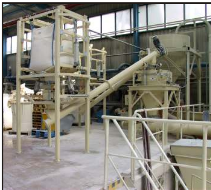
Obr. 1.: Stanice pro vyprazdňování velkoobjemových vaků BIG-BAG - foto zařízení, pohled 2D
