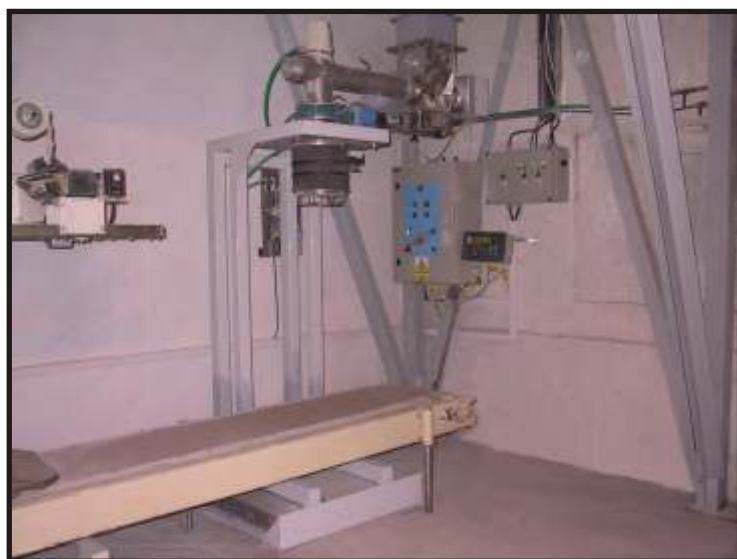
Obr. 1.: Pytlovací váha - foto pytlovací váhy, pohled 2D
