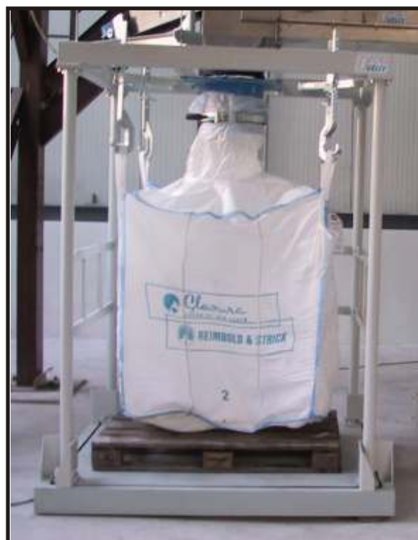
Obr. 1.: Stanice pro plnění velkoobjemových vaků BIG-BAG - pohled 2D a foto zařízení
